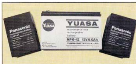
Mynd 6. Þessar gel-eininga blý-sýru rafhlöður eru endurhlaðanlegar og leka ekki.
