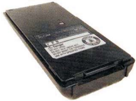
Mynd 4. Li-ion rafhlaða fyrir ICOM handstöð
