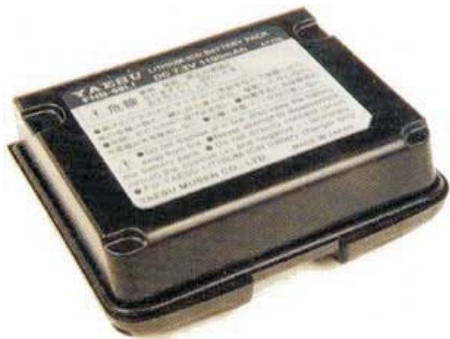
Mynd 5. Lítil Li-ion rafhlaða fyrir Yaesu VX-5R handstöð
