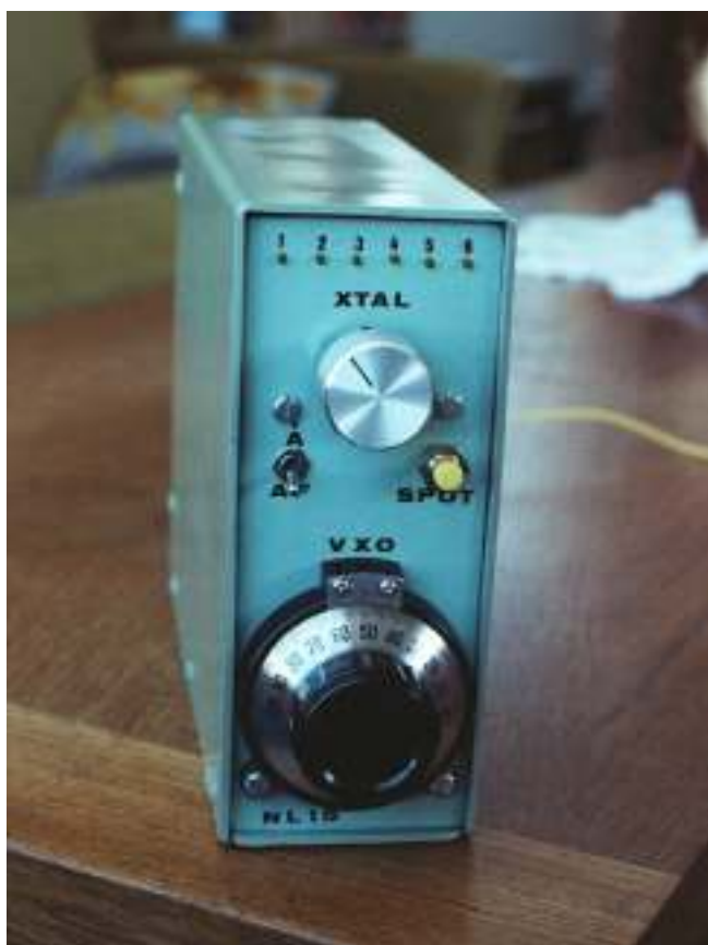
Nú hafði ég semsagt leyfi til að smíða tæki eins og stendur í leyfisbréfinu og nota það. NL 15 er 6 rása sendir á 21 MHz. Vel lukkaður
